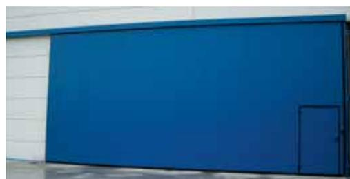
Il portone scorrevole senza guida a terra serie "PSN" è stato progettato per semplificare l'installazione in cantiere anche nel caso di grandi dimensioni; i pannelli infatti possono essere "agganciati" singolarmente sulla guida superiore, e solo successivamente uniti tra loro a formare l'anta completa; al tempo risparmiato nel montaggio, si aggiunge la possibilità di installazione anche senza attrezzatura per carichi pesanti da parte dell'installatore.
